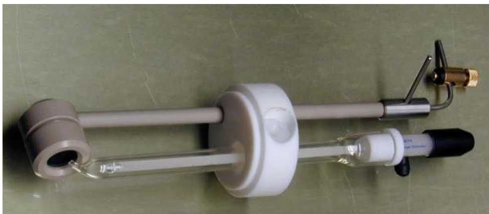
Diskfix mit Gasdiffusionselektrode im Schwenkhalter mit Referenzelektrode
